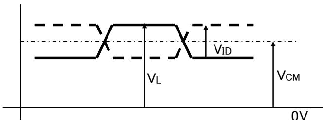
5) V<sub>CM</sub>: LVDS Common mode voltage (V<sub>CM</sub>=1.25V)
