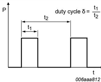
**Fig. 17. Duty cycle definition**
