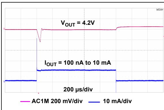
**FIGURE 2-15:** Dynamic Load Step ( $V_R = 4.2\text{V}$ ).
