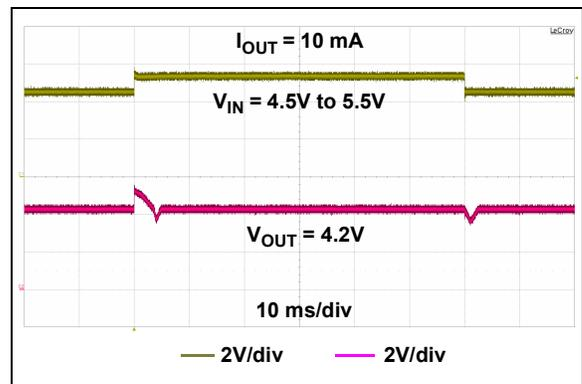
**FIGURE 2-18:** Dynamic Line Step ( $V_R = 4.2\text{V}$ ).
