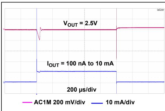
**FIGURE 2-14:** Dynamic Load Step ( $V_R = 2.5\text{V}$ ).
