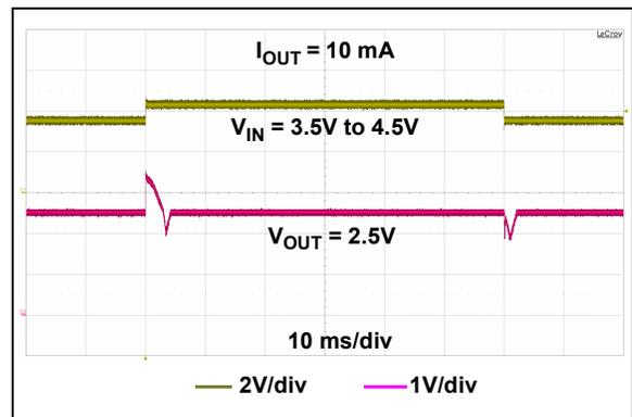
**FIGURE 2-17:** Dynamic Line Step ( $V_R = 2.5\text{V}$ ).
