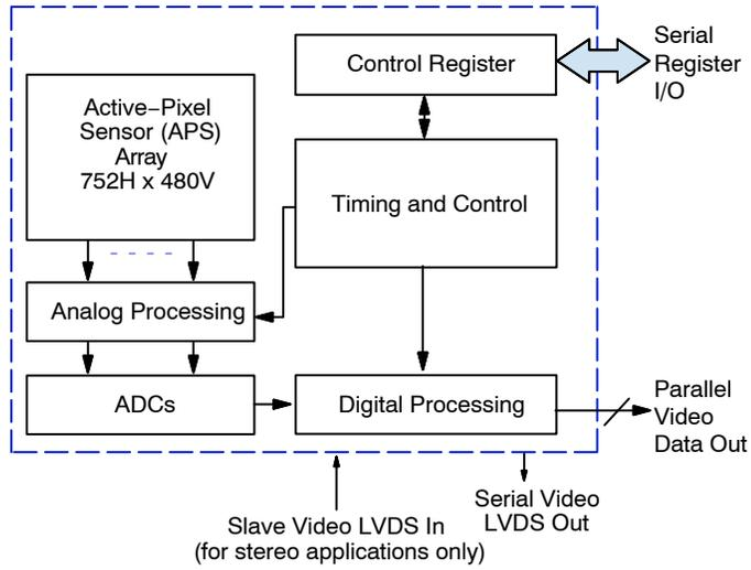
**Figure 1. Block Diagram**
