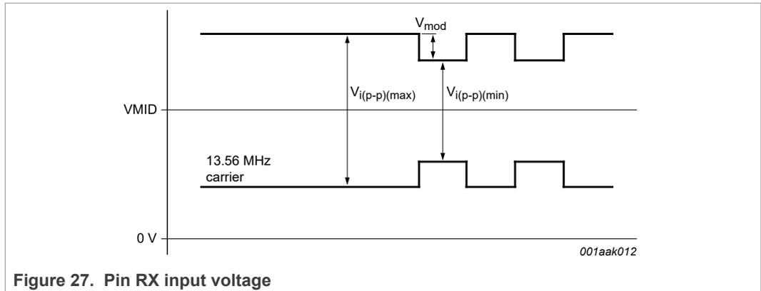
Figure 27. Pin RX input voltage
