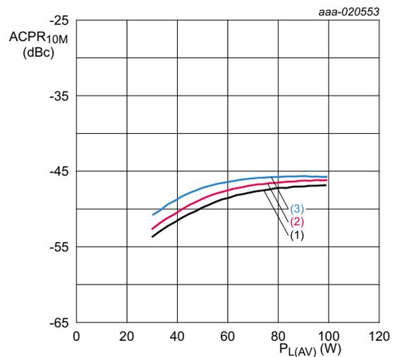
$V_{DS} = 28\text{ V}$ ;  $I_{Dq} = 400\text{ mA}$  (main device);
