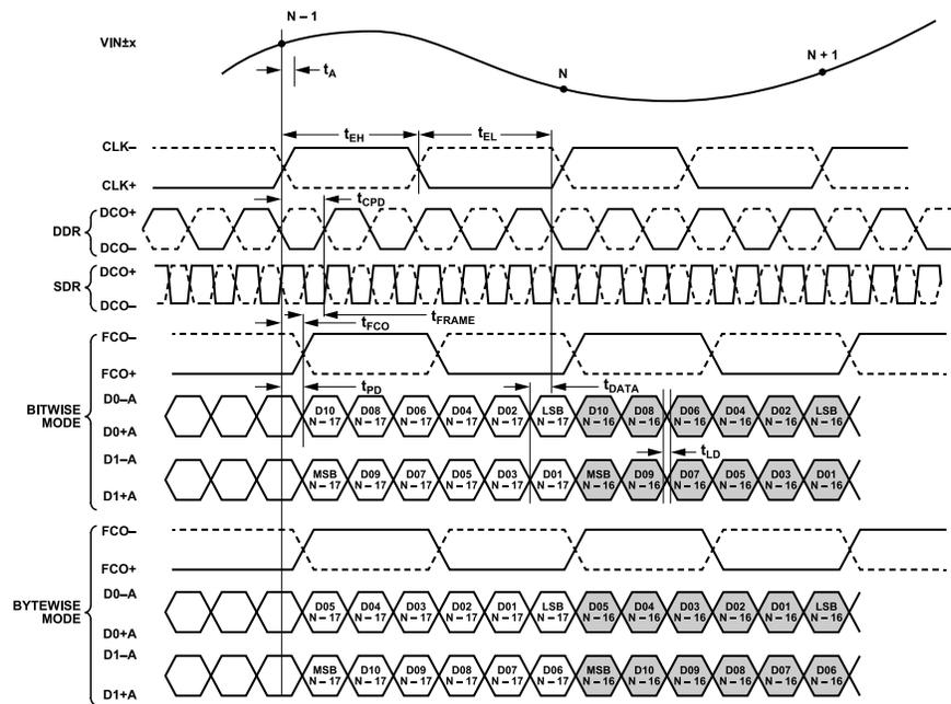
Figure 3. 12-Bit DDR/SDR, Two-Lane, 1x Frame Mode
