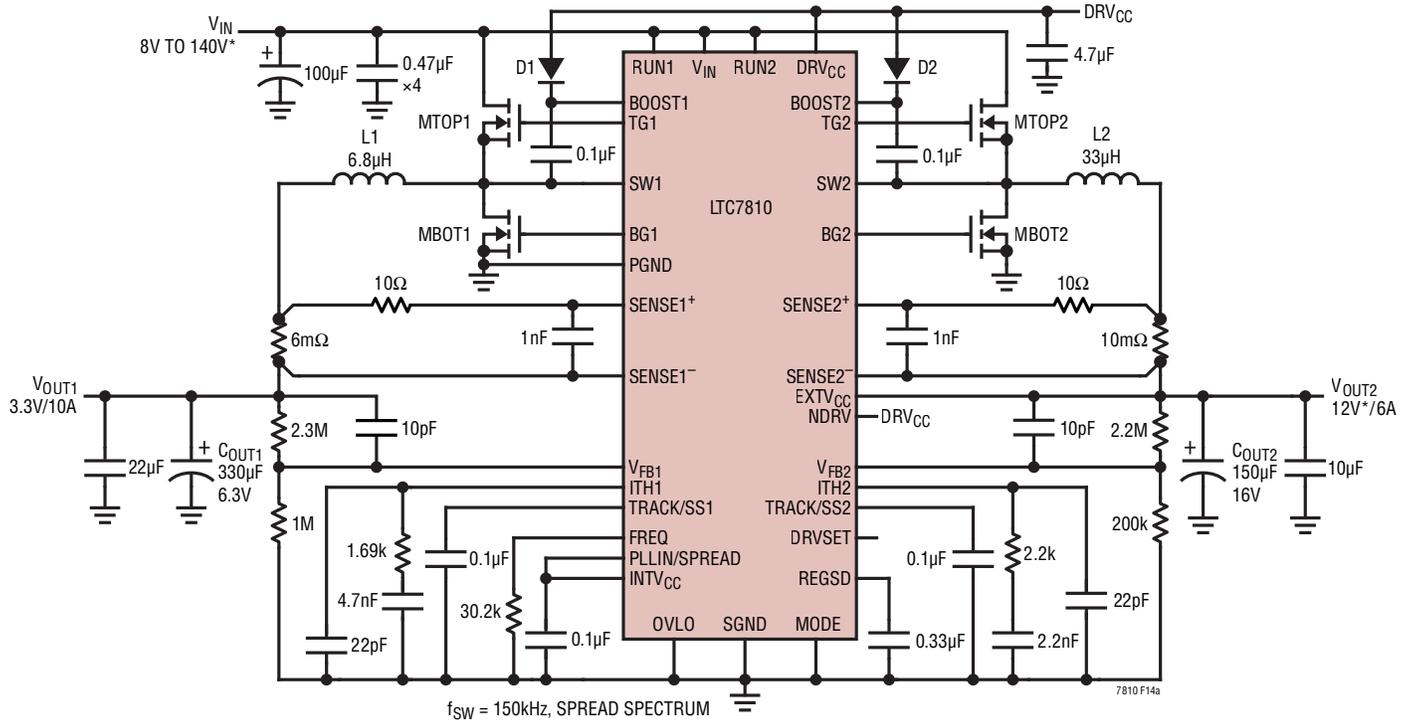
\*  $V_{OUT2}$ , FOLLOWS  $V_{IN}$  WHEN  $V_{IN}$  IS LESS THAN THE REGULATION POINT
