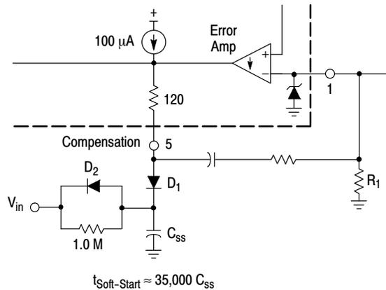
Figure 18. Soft-Start Circuit
