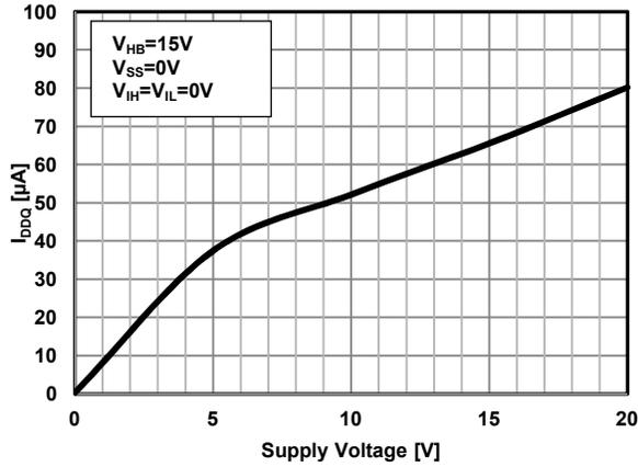
Figure 9. I<sub>DDQ</sub> vs. Supply Voltage(V<sub>DD</sub>)
