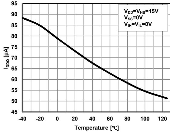
Figure 10. I<sub>DDQ</sub> vs. Temp.
