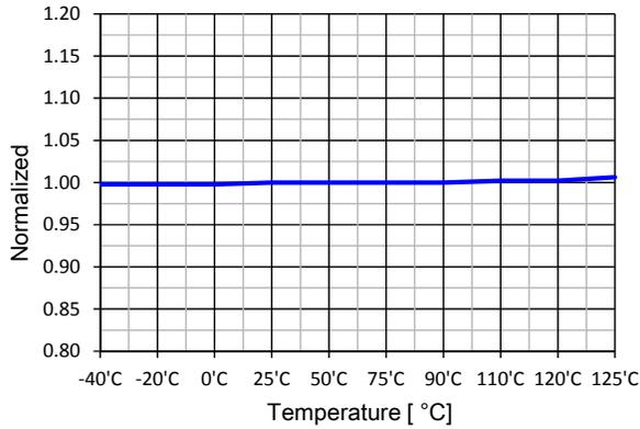
Figure 11. UVLO Threshold Voltage ( $V_{\text{START}}$ ) vs.  $T_A$
