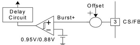
Figure 22. Burst-Mode Block
