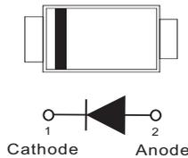
**SOD-923** Unit : inch(mm)
