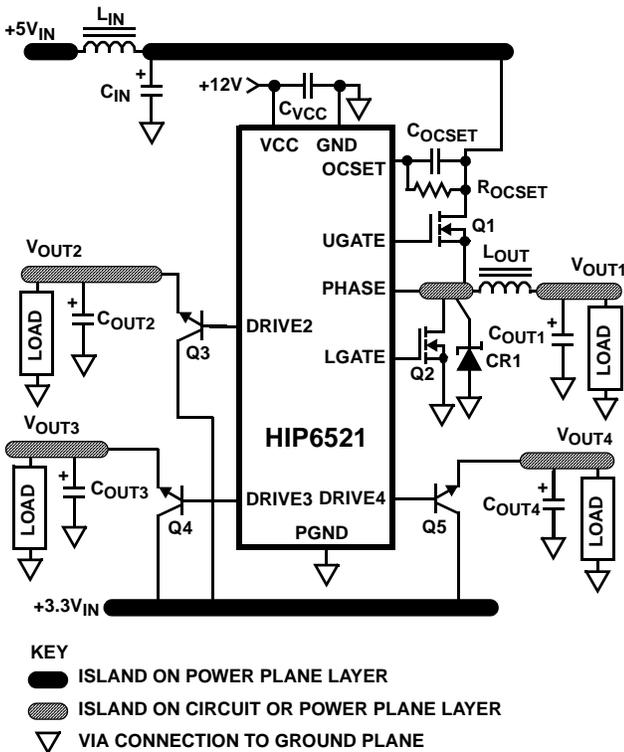
FIGURE 5. PRINTED CIRCUIT BOARD POWER PLANES AND ISLANDS
