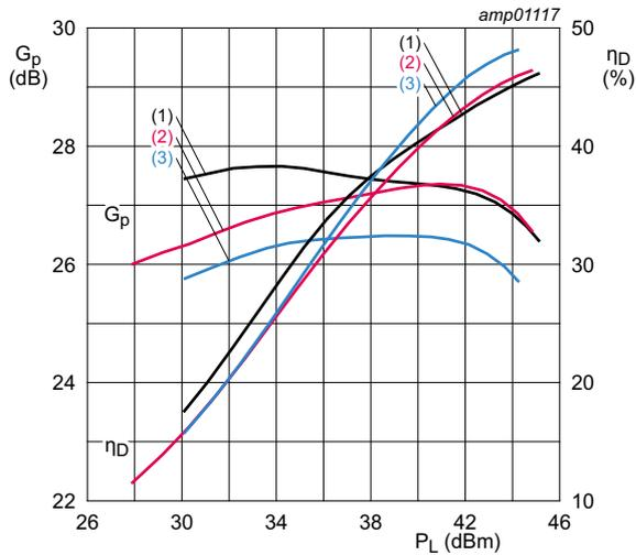
$T_{case} = 25\text{ }^{\circ}\text{C}$ ;  $V_{DS} = 30\text{ V}$ ;
