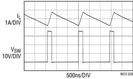
36V<sub>IN</sub> TO 5V<sub>OUT</sub> AT 2A
