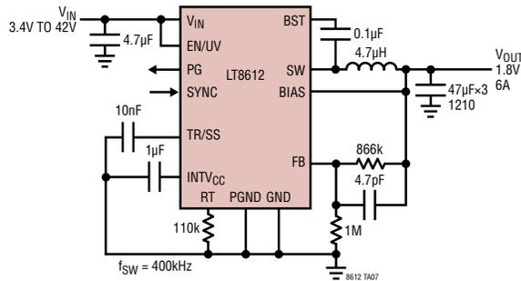
Ultralow EMI 5V 6A Step-Down Converter
