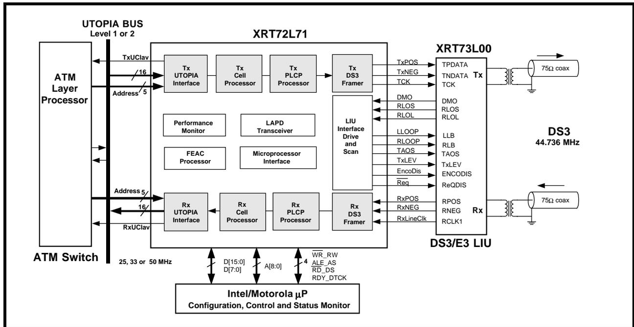
FIGURE 2. BLOCK DIAGRAM OF THE XRT72L71 DS3 UNI
