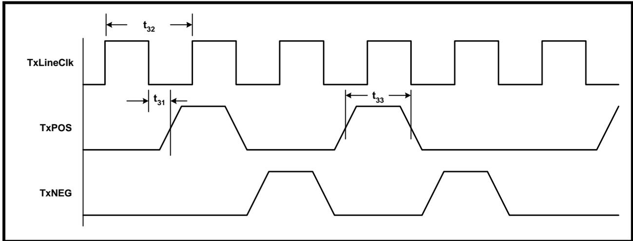
**FIGURE 10. RECEIVE DS3 FRAMER—OH BIT SERIAL OUTPUT PORT INTERFACE TIMING**
