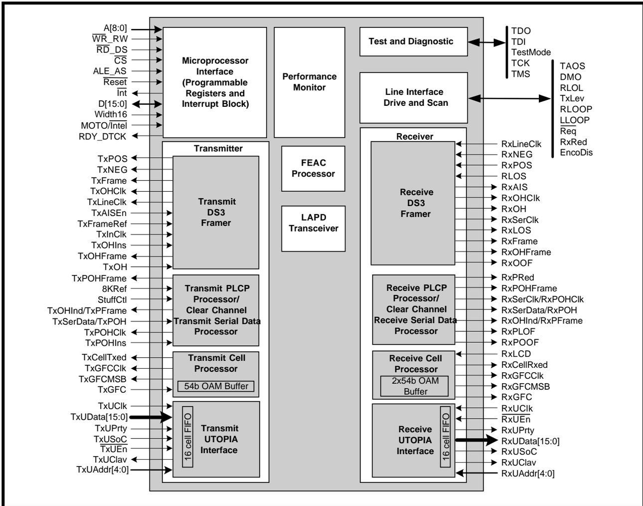
**FIGURE 3. PIN OUT OF THE XRT72L71 DS3 ATM UNI**
