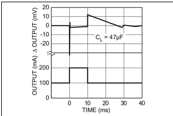
**FIGURE 2-15:** Load Transient.
