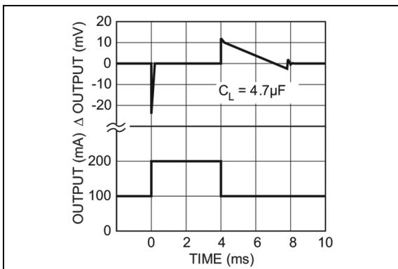
**FIGURE 2-14:** Load Transient.
