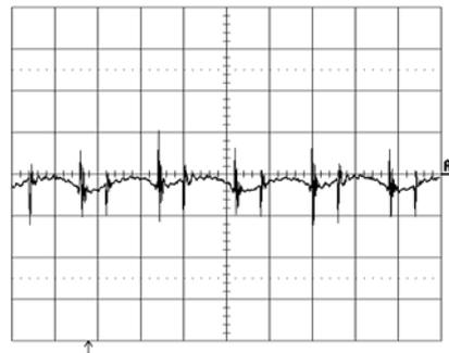
Output voltage ripple (20mV/div.) at:
