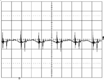
Output voltage ripple (20mV/div.) at:
