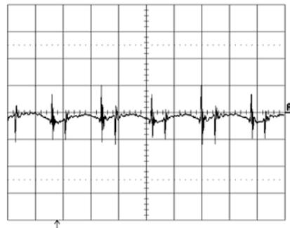
Output voltage ripple (20mV/div.) at:
