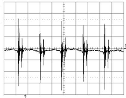
Output voltage ripple (20mV/div.) at:
