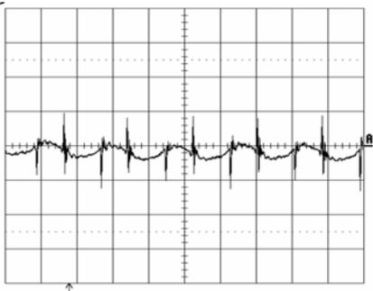
Output voltage ripple (20mV/div.) at:
