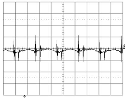
Output voltage ripple (20mV/div.) at:
