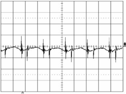
Output voltage ripple (20mV/div.) at:
