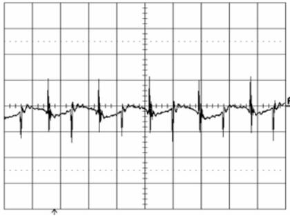
Output voltage ripple (20mV/div.) at:
