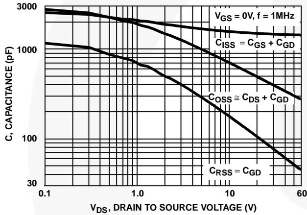
FIGURE 13. CAPACITANCE vs DRAIN TO SOURCE VOLTAGE
