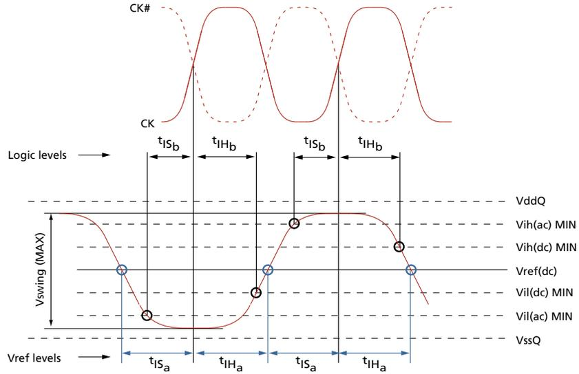
Figure 31: AC Input Test Signal Waveform for Data with DQS, DQS# (Differential)
