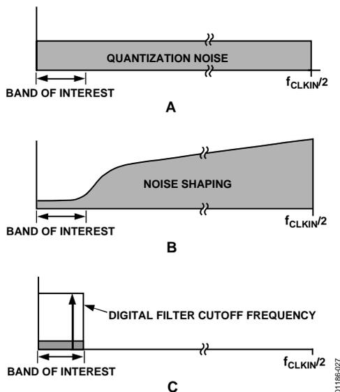
Figure 27. Sigma-Delta ADC
