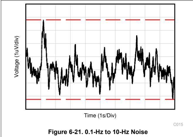
**Figure 6-21. 0.1-Hz to 10-Hz Noise**
