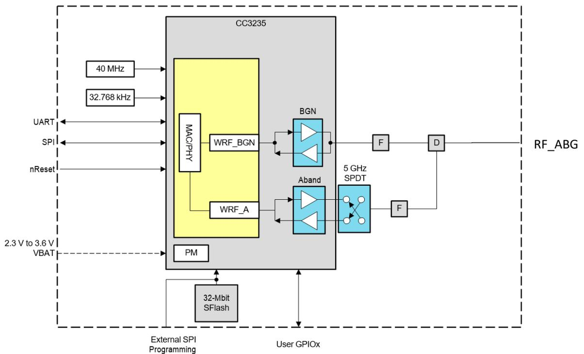
**Figure 2-1. BDE-WF3235 Module Block Diagram**
