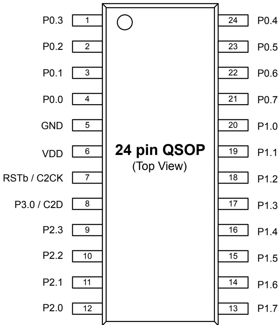
Figure 6.2. EFM8BB2x-QSOP24 Pinout
