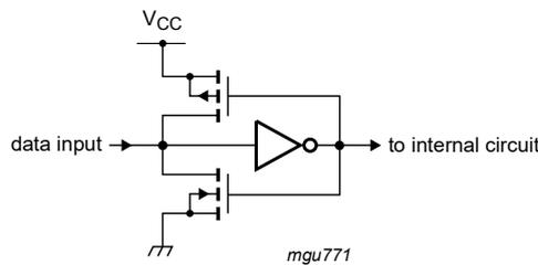
Fig. 4. Bus hold circuit
