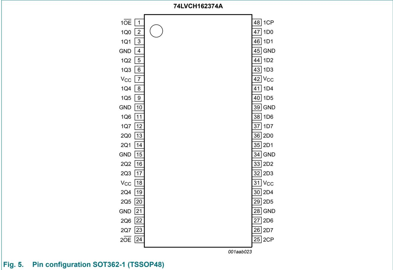
Fig. 5. Pin configuration SOT362-1 (TSSOP48)
