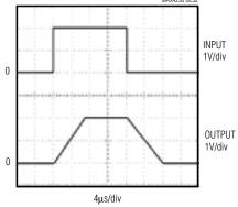
$$\begin{split} &V_{CC}=\pm 2.5V\\ &R_L=1k\Omega,\;C_L=15pF\\ &A_V=1V/V \end{split}$$
