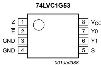
Fig. 3. Pin configuration SOT505-2 (TSSOP8) and SOT765-1 (VSSOP8)
