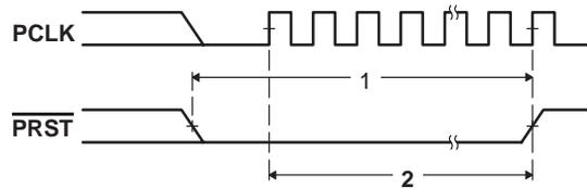
Figure 31. PCI Reset ( $\overline{\text{PRST}}$ ) Timings
