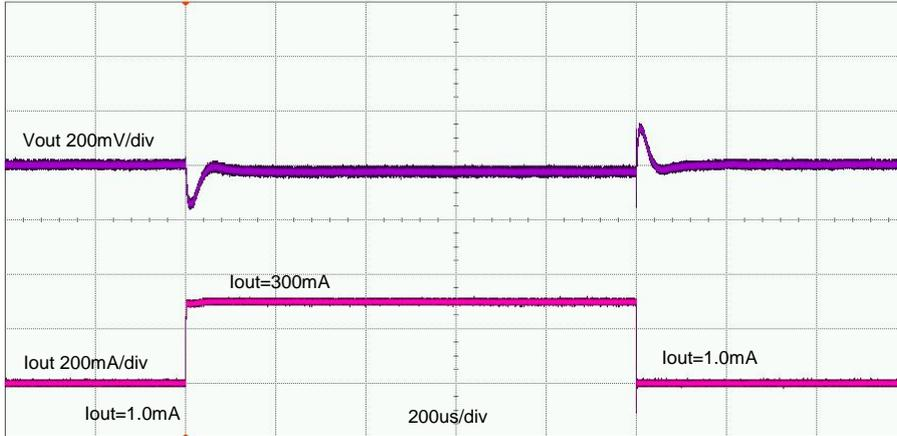
• XCL103D503CR-G,  $V_{IN}=3.7V$ ,  $V_{OUT}=5.0V$ ,  $I_{OUT}= 1.0mA \leftrightarrow 300mA$ ,  $T_a=25^{\circ}C$
