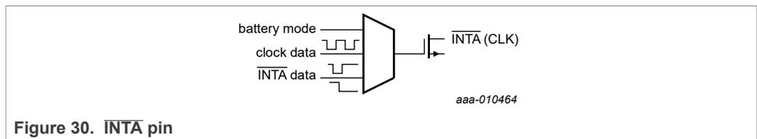
Figure 30.  $\overline{\text{INTA}}$  pin
