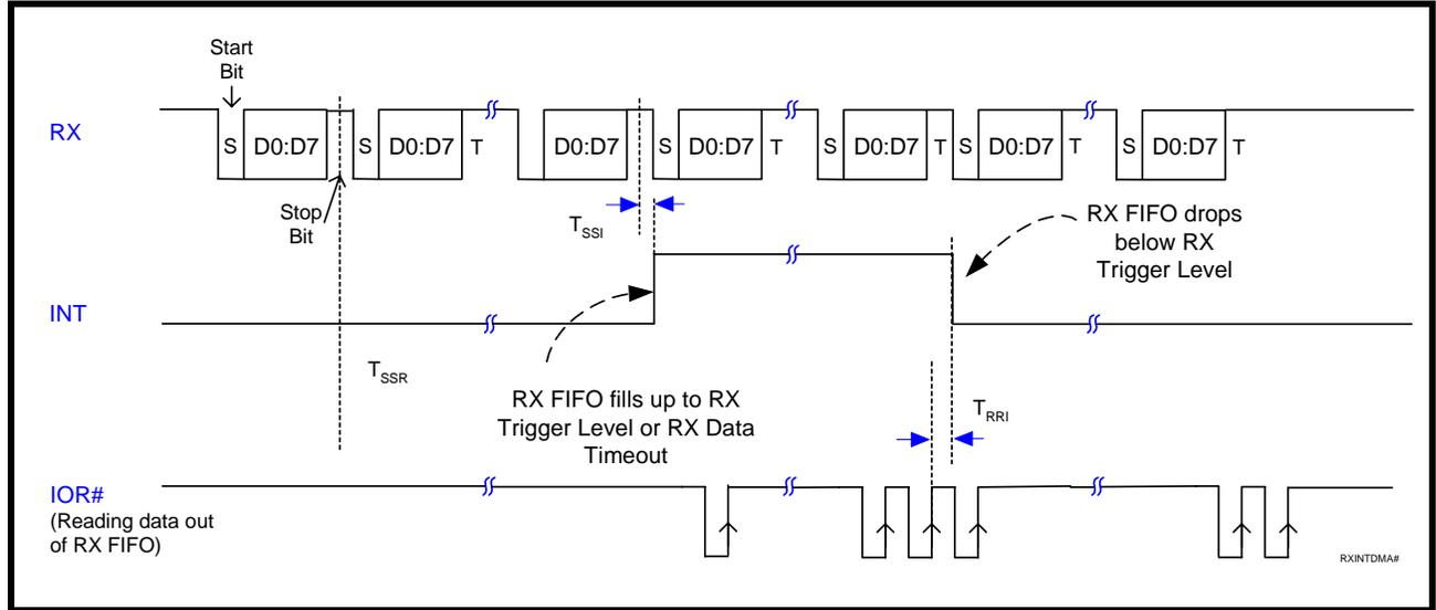
**FIGURE 21. TRANSMIT READY INTERRUPT TIMING [FIFO MODE]**
