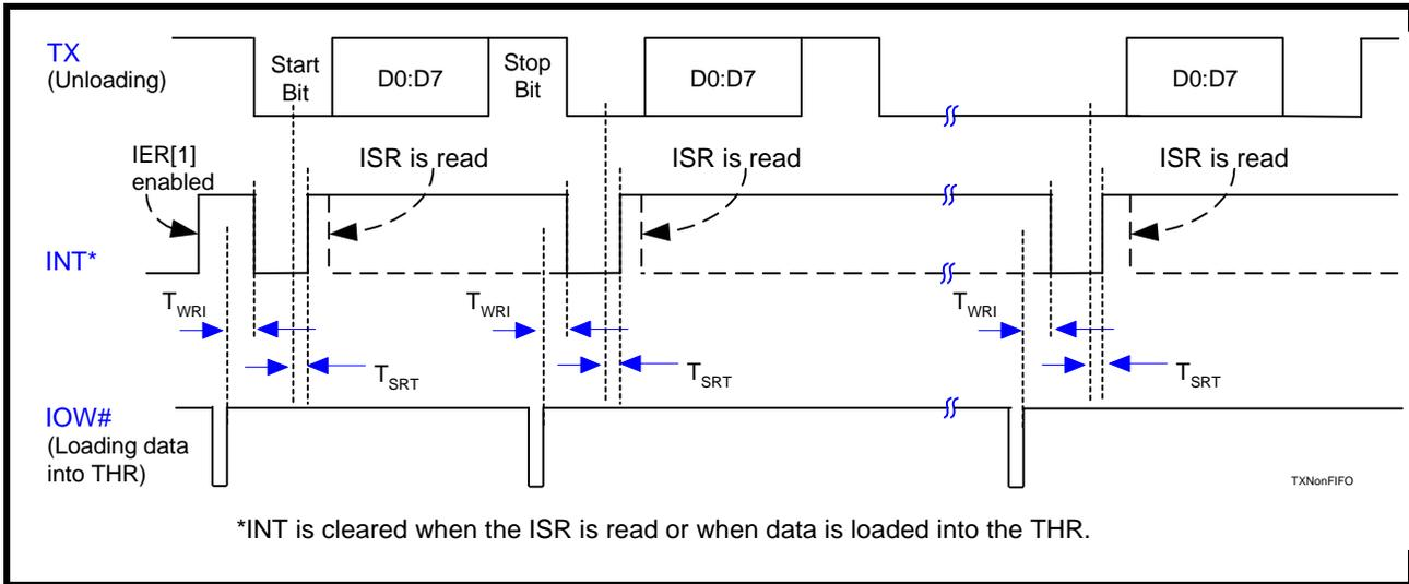
**FIGURE 20. RECEIVE READY INTERRUPT TIMING [FIFO MODE]**
