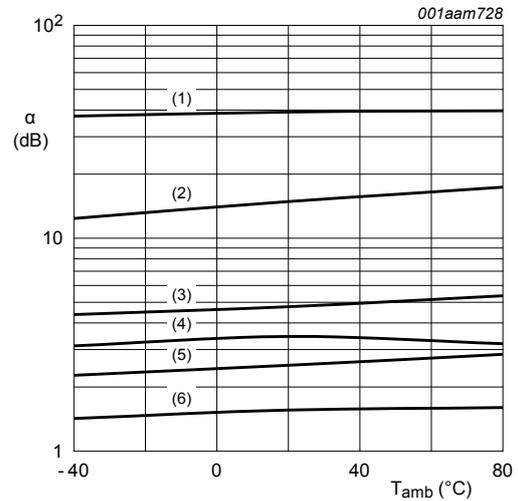
$V_{CC} = 0.75\text{ V}; f = 1000\text{ MHz}.$
