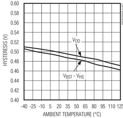
**UNDERVOLTAGE LOCKOUT RESPONSE (V<sub>DD</sub> RISING)**
