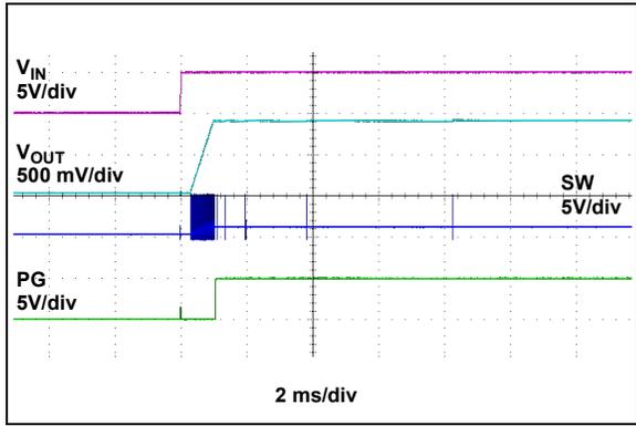
**FIGURE 2-18:**  $V_{IN}$  Turn-On ( $EN = PV_{IN}$ ).
