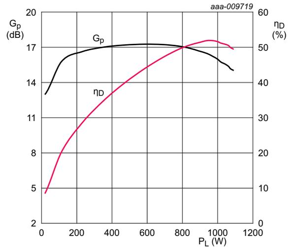
$V_{DS} = 50\text{ V}$ ;  $I_{Dq} = 200\text{ mA}$ ;  $f = 1030\text{ MHz}$ ;  $t_p = 50\text{ }\mu\text{s}$ ;  $\delta = 2\%$ .
