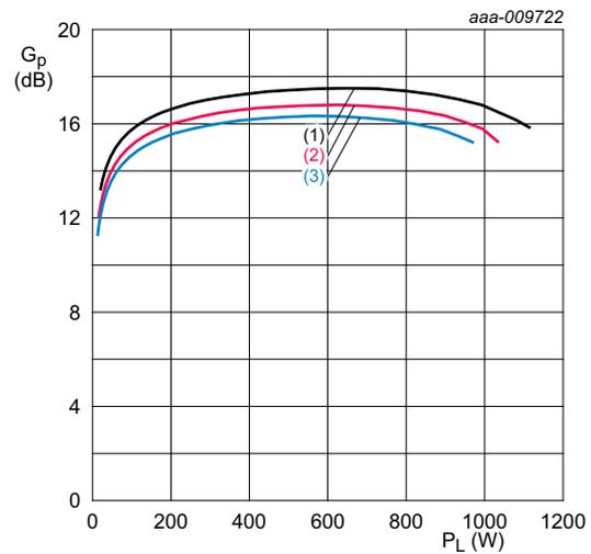
$V_{DS} = 50\text{ V}$ ;  $I_{Dq} = 200\text{ mA}$ ;  $f = 1030\text{ MHz}$ ;  $t_p = 50\text{ }\mu\text{s}$ ;  $\delta = 2\%$ .
