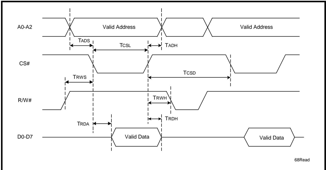
**FIGURE 18. 68 MODE (MOTOROLA) DATA BUS WRITE TIMING**
