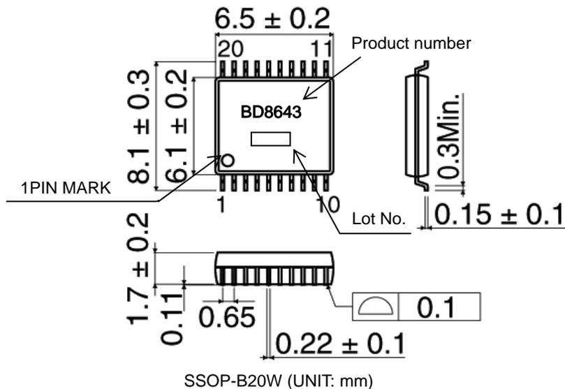
SSOP-B20W (UNIT: mm)
