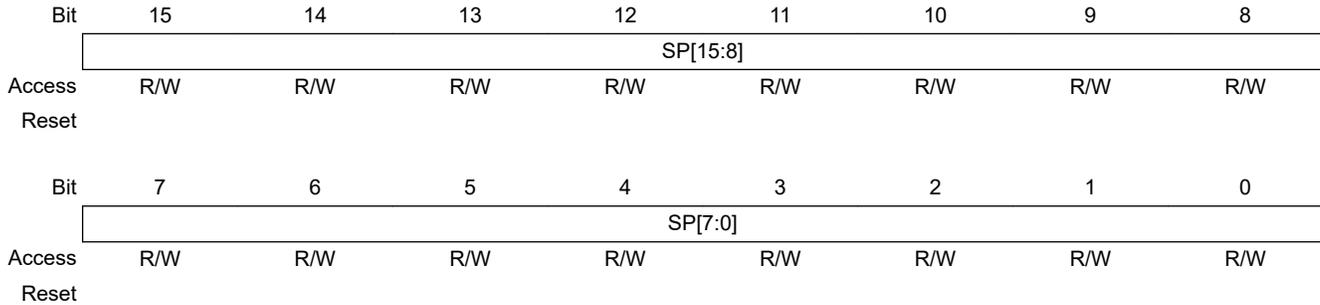
**Bits 15:8 – SP[15:8]** Stack Pointer High Byte
