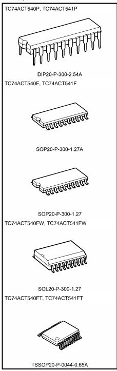
DIP20-P-300-2.54A : 1.30 g (typ.) SOP20-P-300-1.27A : 0.22 g (typ.) SOP20-P-300-1.27 : 0.22 g (typ.) SOL20-P-300-1.27 : 0.46 g (typ.) TSSOP20-P-0044-0.65A : 0.08 g (typ.)
