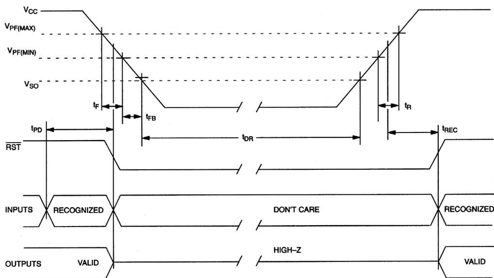
**POWER-UP/DOWN CHARACTERISTICS** $(V_{CC} = 3.3V \pm 10\%)$
