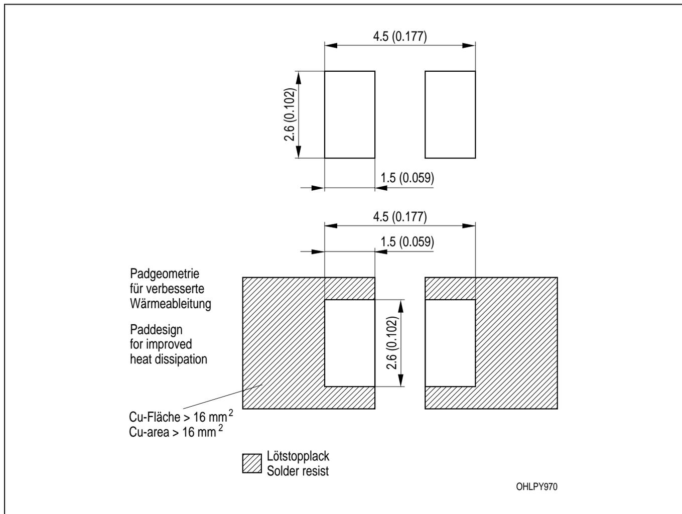
Maße werden wie folgt angegeben: mm (inch) / Dimensions are specified as follows: mm (inch)
