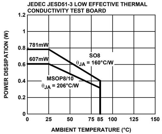
FIGURE 42. PACKAGE POWER DISSIPATION vs AMBIENT TEMPERATURE
