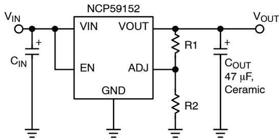
$$V_{OUT} = 1.24 \text{ V} \cdot \left( 1 + \frac{R1}{R2} \right) + I_{ADJ} \cdot R1$$
