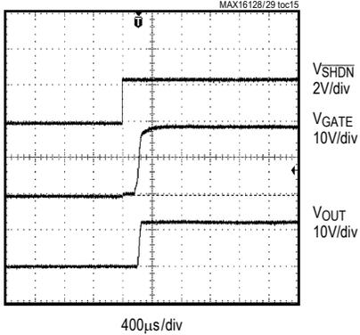
**OVERVOLTAGE SWITCH FAULT**
