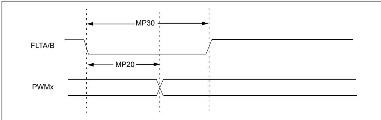
**FIGURE 26-10: MOTOR CONTROL PWM MODULE TIMING CHARACTERISTICS**
