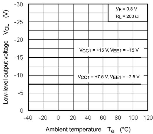
**Fig. 12.2.7  $V_{OL} - T_a$**
