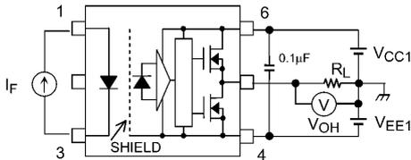
Fig. 12.1.3  $V_{OH}$  Test Circuit
