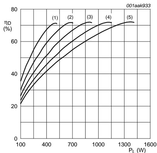
$I_{Dq} = 40\text{ mA}$ ;  $f = 225\text{ MHz}$ ;  $t_p = 100\ \mu\text{s}$ ;  $\delta = 20\%$ .
