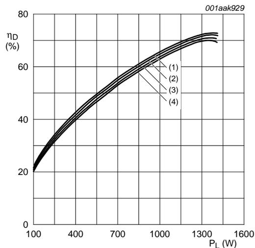
$V_{DS} = 50\text{ V}$ ;  $f = 225\text{ MHz}$ ;  $t_p = 100\ \mu\text{s}$ ;  $\delta = 20\%$ .
