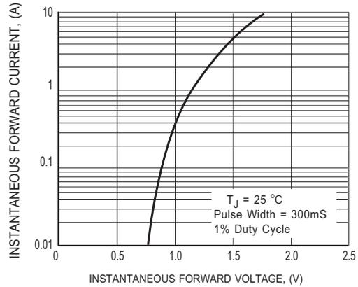
**FIG.5 MAXIMUM INSTANTANEOUS FORWARD CHARACTERISTICS**
