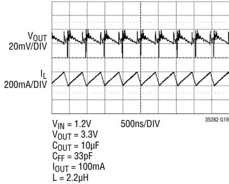
**Burst Mode Waveforms**
